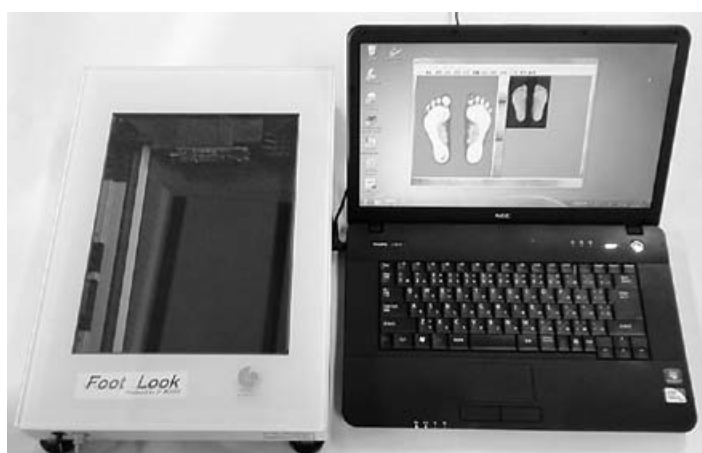
図1 足裏バランス測定装置「Foot Look」による足部・足趾の形態の測定
