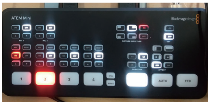
図4. 使用したライブプロダクションビデオスイッチャー Blackmagic Design社製, ATEM Mini
